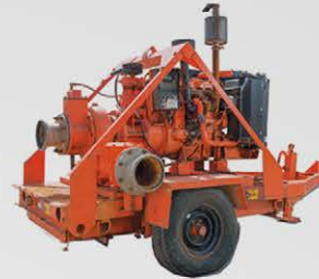
Bomba de agua
